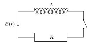
Stromkreis mit einem Ohmschen Widerstand R und einem induktiven Widerstand (Spule, Induktionskoeffizient L)
