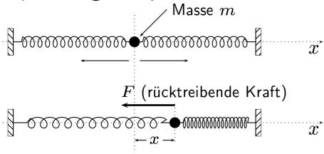
Federschwingung: Rücktreibende Kraft (F) ist proportional zur Auslenkung (-x)
